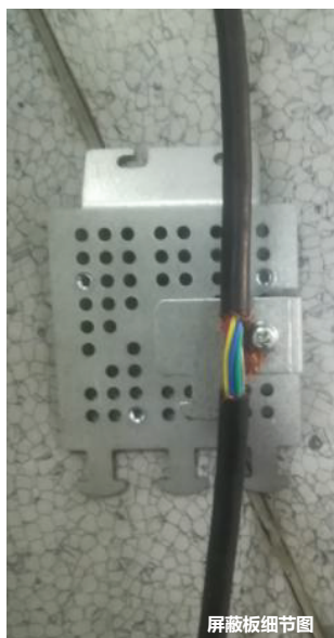
功率模块B1的电磁兼容布线
