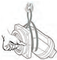
图5：马达起吊示意图
